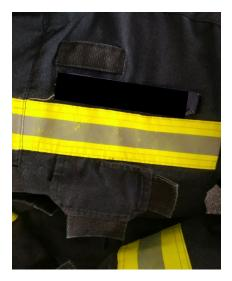
**Beispiel:** Abnutzung der silbernen Reflexschicht durch Verwendung optischer Aufheller / Bleichmittel im Waschmittel
