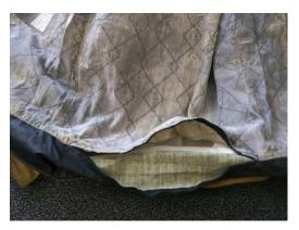
**Beispiel:** Zersetzung Futter aufgrund Reaktion von Schweißrückständen (Salze) unter Sonneneinwirkung
