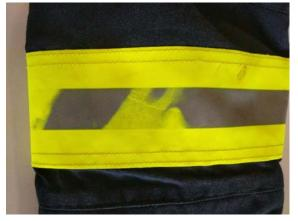
**Beispiel:** Verlaufspuren einer unbekannten Flüssigkeit im Reflexstreifen (Korrosion aufgrund einer Kontamination)
