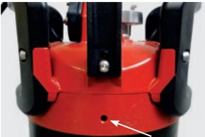
Kontrollöffnung für Gleitringdichtung
