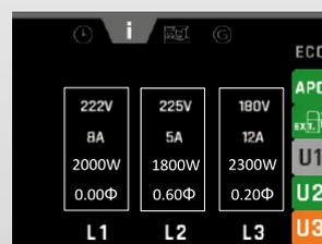
In der **Expertenansicht** sieht man den Status der angeschlossenen Verbraucher mit noch mehr Details. Spannung, Strom, Wirkleistung und Cosinus Phi werden je Phase genau aufgeschlüsselt. Dadurch wird im Falle eines Fehlers die Suche nach den Ursachen wesentlich erleichtert.
