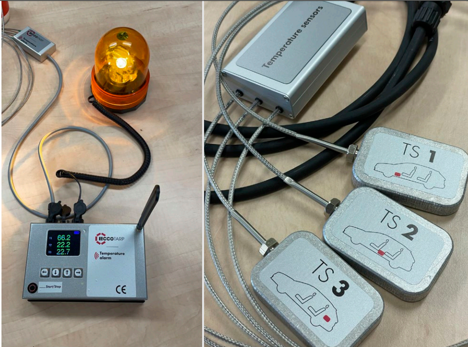
Beispiel einer Batterieübertemperatur-Warmmeldung
