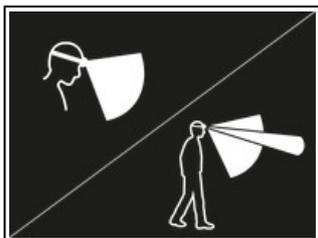
Der breite, homogene Lichtkegel bietet eine komfortable Sicht für Arbeiten im unmittelbaren Nahbereich, während der kombinierte Lichtkegel die Fortbewegung erleichtert.
